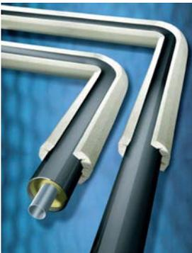
Der Hauseinführungsbogen (HEB) wird mit Schaumstoffdehnpolstern am Bogenteil angeliefert. Der 90° Bogen muss **mit** diesem Schaumstoff-Dehnpolstern eingebaut werden, damit sich das Rohr ausdehnen kann.
